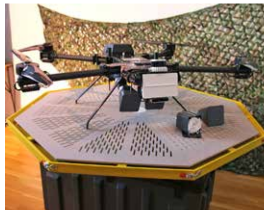
Eine von Härtenberger entwickelte Landeplattform für Einsätze hochwertiger Drohnen.
